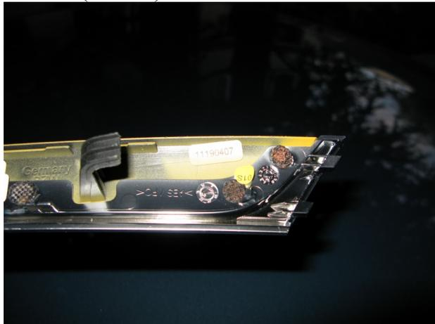
Enlever le cache en forme de boomerang, toujours à l'aide du levier en silicone. Le cache côté passager se déclipse assez facilement. Celui de la porte conducteur est beaucoup plus coriace : il est mieux maintenu, du fait de l'interrupteur. Commencer par le bas du boomerang. Attention à ne pas marquer le cuir ni à déformer le cache, qui est en plastique assez tendre.
